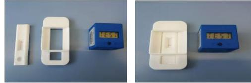
8. Den CUBE®-Reader über dem Adapter platzieren. Eine abgeschrägte Ecke am CUBE®-Reader und ein entsprechendes Gegenstück im Adapter helfen dabei, die korrekte Position zu finden. Der CUBE®-Reader zeigt **TEST** an und ist bereit, die Messung durchzuführen. Um die Messung zu starten, kurz die Bedientaste drücken (<1 Sekunde).
