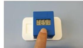
9. Der CUBE®-Reader führt die Messung in wenigen Sekunden durch, auf dem Display steht währenddessen **RUN**.
